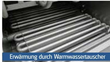
Erwärmung durch Warmwassertauscher
