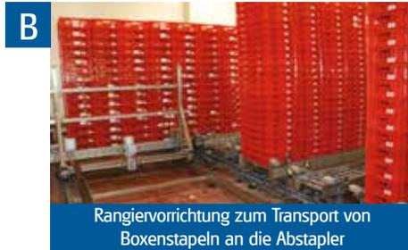
Rangiervorrichtung zum Transport von Boxenstapeln an die Abstapler
